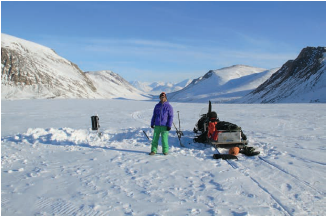
Abb. 3: GPS-Station am A.P.Olsen Ice Cap; Solarpanels müssen nach dem Winter freigelegt werden
