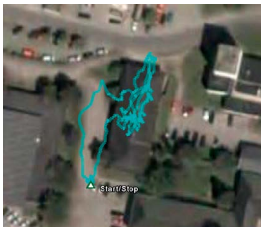
Abb. 8: Gemessene Trajektorie im Vektormodus
